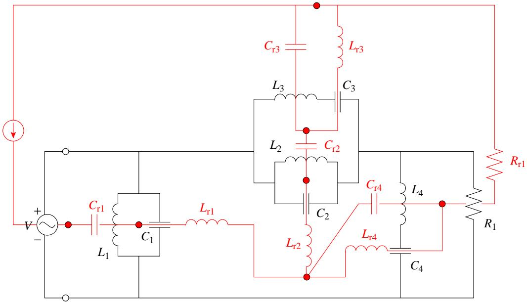
上の図の電流源を削除し，赤で示した回路を整理すると，解答 1 の逆回路を得ることができる．
