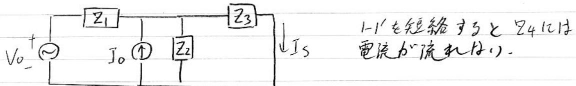
↓ 電圧源を電流源に変換する
