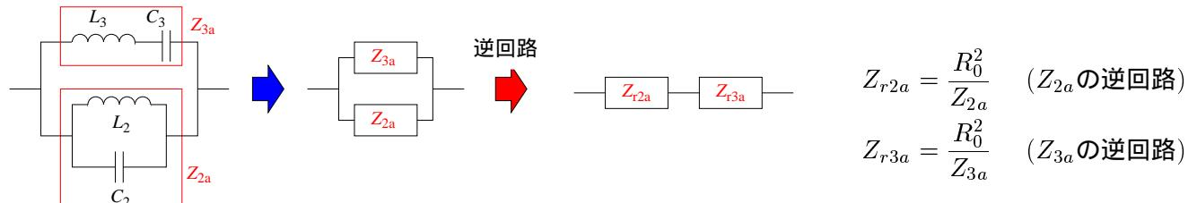
したがって、全体の逆回路は下図左のよになり、 $Z_{r2a}$ ,  $Z_{r3a}$ ,  $Z_{r1b}$  の部分にそれぞれ、 $Z_{2a}$ ,  $Z_{3a}$ ,  $Z_{1b}$  の逆回路を入れると、下図右のように逆回路が求まる .
