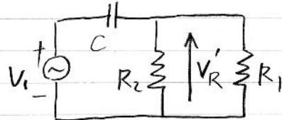
$$R_1 \parallel R_2 = \frac{R_1 R_2}{R_1 + R_2} = R_{12} \text{ である}$$
