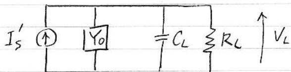
RL にかかる電圧  $V_L$  は  $G_L = 1/R_L$ ,  $B_L = \omega C_L$  とおくと
