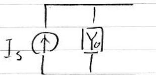
$$I_S = \frac{Z_2(Z_1 I_0 + V_0)}{Z_1 Z_2 + Z_2 Z_3 + Z_3 Z_1}$$
