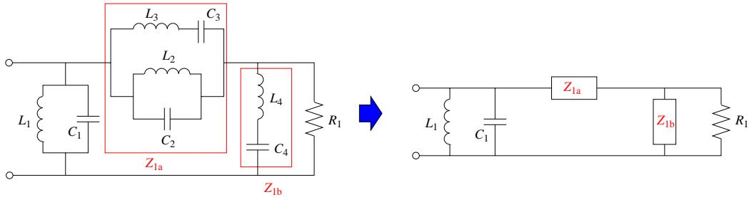
上図右の回路の逆回路を求めるに、以下のようになる .
