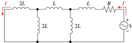
図の回路で抵抗  $R$  より左側の合成インピーダンスを求めると、左から順にインピーダンスを合成していくと  $j\omega \cdot 2L$  となるので、電源から出る電流  $I'$  は
