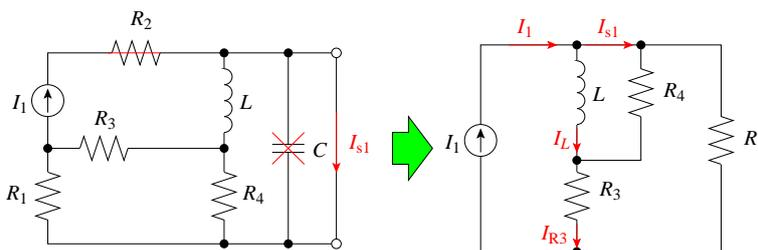
図の回路で、短絡電流  $I_{s1}$  は  $I_1 - I_L$  で計算できる。  $R_3, R_4, L$  の合成インピーダンス  $Z$  は
