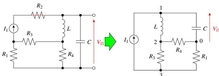
ここで、図のように節点番号を付け、節点0の電位を0とすると、求める電圧は節点1の電位として求まる。節点1, 2, 3の電位をそれぞれ  $V'_1, V'_2, V'_3$  として図の回路の節点方程式を立てると
