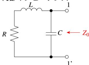
$$Z_0 = (R + j\omega L) // \left( \frac{1}{j\omega C} \right) = \frac{(R + j\omega L) \cdot \frac{1}{j\omega C}}{R + j\omega L + \frac{1}{j\omega C}} = \frac{(5 + j5) \cdot (-j5)}{5 + j5 - j5} = \frac{25 - j25}{5}$$
