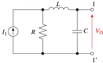
$$V_{f1} = \frac{R}{R + (j\omega L + \frac{1}{j\omega C})} \cdot I_1 \cdot \frac{1}{j\omega C} = \frac{5}{5 + j5 - j5} \cdot 1 \cdot (-j5) = -j5 \text{ V}$$
