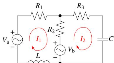
$$\begin{bmatrix} V_a - V_b \\ V_b \end{bmatrix} = \begin{bmatrix} R_1 + R_2 + j\omega L & -R_2 \\ -R_2 & R_2 + R_3 + \frac{1}{j\omega C} \end{bmatrix} \begin{bmatrix} I_1 \\ I_2 \end{bmatrix}$$
