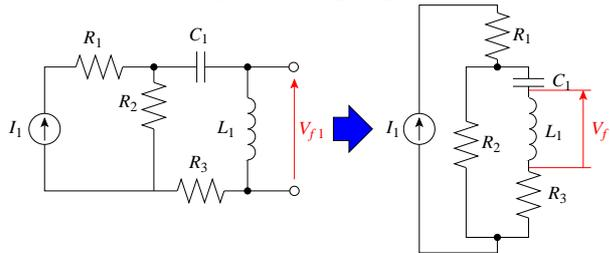
$V_{f1}$  は以下のように求まる (分流の法則で  $L_1$  に流れる電流を求め， $j\omega L_1$  に乗じる)
