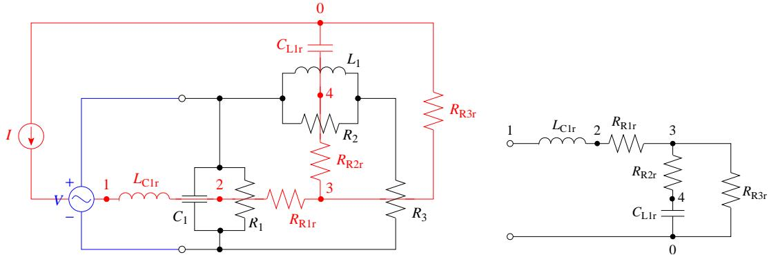
与えられた素子値に対して，元の回路のインピーダンスと，逆回路のインピーダンスを計算してみる．まず，元の回路に対しては， $j\omega L_1 = j\omega L_2 = j\Omega$ ， $1/j\omega C_1 = 1/j\omega C_2 = -j2\Omega$  であるので，右から順にインピーダンスを合成していくと
