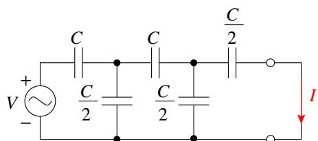
図より、電源から右を見た合成容量を計算すると、 $C/2$  となる。したがって、電源から出る電流は
