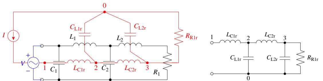
与えられた素子値に対して、元の回路のインピーダンスと、逆回路のインピーダンスを計算してみる。まず、元の回路に対しては、 $j\omega L_1 = j\omega L_2 = j \Omega$ ,  $1/j\omega C_1 = 1/j\omega C_2 = -j2 \Omega$  があるので、右から順にインピーダンスを合成していくと
