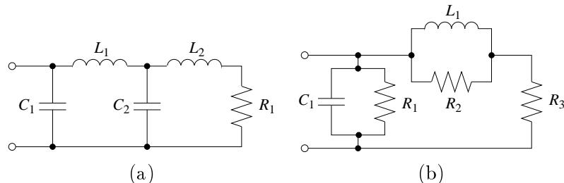
3. 以下の回路の電流  $I$  を求めよ. (相反定理を利用すると計算が楽)
