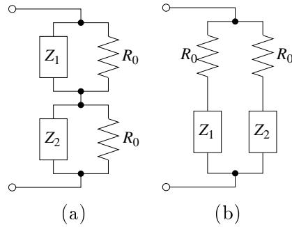
2. 以下の回路の逆回路を次の 2 通りの方法でそれぞれ求めよ. (1) 直列  $\leftrightarrow$  並列の変換を行う方法. (1) 図的解法. また,  $R_0 = 1 \Omega$ ,  $R_1 = R_2 = R_3 = 2 \Omega$ ,  $L_1 = L_2 = \frac{1}{100\pi} H$ ,  $C_1 = C_2 = \frac{1}{200\pi} F$ ,  $f = 50 Hz$  とするとき, 元の回路と逆回路のインピーダンスの積が  $R_0^2$  になることを確認せよ.
