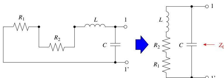
$$Z_0 = (R_1 + R_2 + j\omega L) // \frac{1}{j\omega C} = 5(1+j) // (-j5) = \frac{5(1+j) \cdot (-j5)}{5 + j5 - j5} = 5(1-j) \Omega$$
