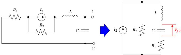
まず , コンデンサに流れる電流  $I_C$  を求める
