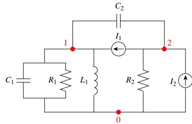
$$\begin{bmatrix} I_1 \\ I_2 - I_1 \end{bmatrix} = \begin{bmatrix} \frac{1}{R_1} + j\omega(C_1 + C_2) + \frac{1}{j\omega L_1} & -j\omega C_2 \\ -j\omega C_2 & \frac{1}{R_2} + j\omega C_2 \end{bmatrix} \begin{bmatrix} V_1 \\ V_2 \end{bmatrix}$$
