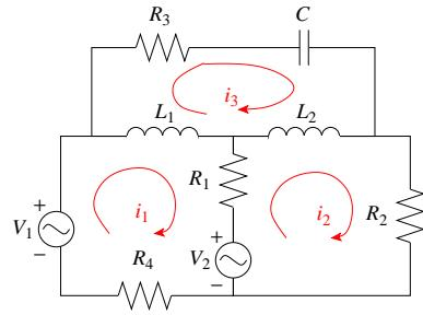
$$\begin{bmatrix} V_1 - V_2 \\ V_2 \\ 0 \end{bmatrix} = \begin{bmatrix} (R_1 + R_4) + j\omega L_1 & -R_1 - j\omega L_1 & 0 \\ -R_1 & (R_1 + R_2) + j\omega L_2 & -j\omega L_2 \\ -j\omega L_1 & -j\omega L_2 & R_3 + j\omega(L_1 + L_2) + \frac{1}{j\omega C} \end{bmatrix} \begin{bmatrix} I_1 \\ I_2 \\ I_3 \end{bmatrix}$$
