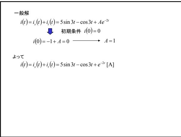
図の回路で時刻  $t=0$  にスイッチが閉じた後の電流の時間変化をラプラス変換を用いて求めよ。ただし、 $t < 0$  ではコンデンサに電荷はないものとする。
