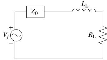
いま、 $R_L$ ,  $L_L$  を独立に変化させることができるとき、最大電力伝送定理より、 $R_L$ ,  $L_L$  の最適値は
