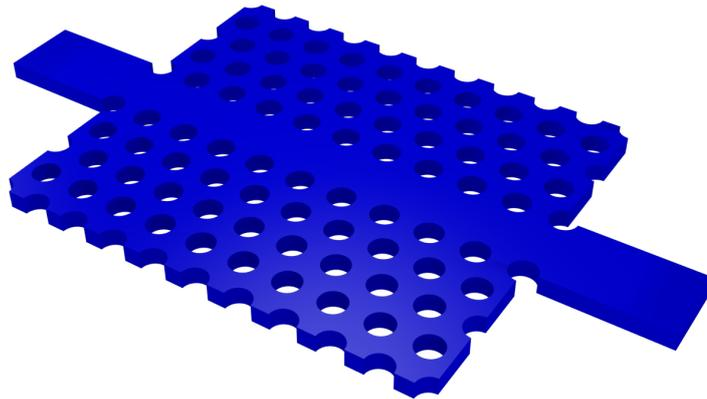
同様にして作成した PCF の画像を以下に示す。材質にガラスを設定している。
