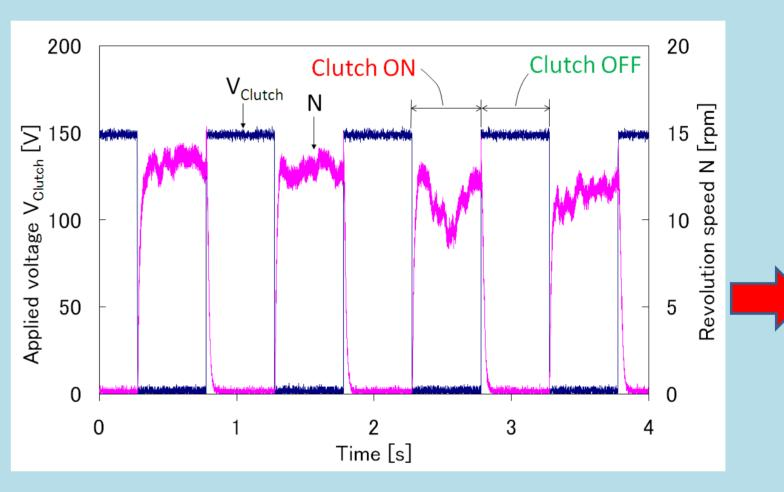
**Clutch ON**: Rotation **Clutch OFF**: Free
