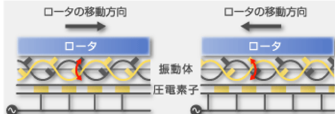
セイコーインスツル株式会社 マイクロ超音波モータ http://www.sii.co.jp/info/micro-usm1.html
