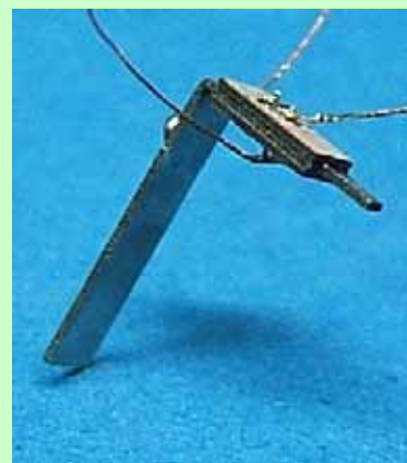
電極表面に極細のエナメル線を はんだ付けしている
