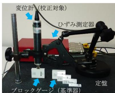
写真 1 変位校正試験装置
