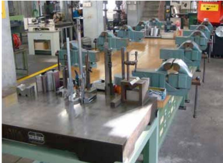
定盤には大小種々あり、その面の辺の寸法をもって大きさを表わす。(例えば、300mm×300mm とか 900mm×600mm の定盤というように表わす。) 良好な定盤は自然のシーズニングを行ない内部応力を除去したもので、いわゆるよく枯らして加工したもので製作している。
