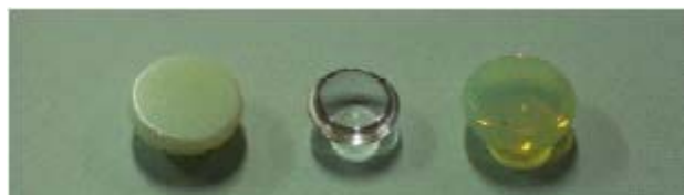
写真1 平面研磨例 左から順に不透明ガラス従来研削（指でさわっても荒さがわかる） 透明ガラス本学透明研磨（中心部が微妙にくぼんでいる）、 半失透ガラス研修研磨（顕微鏡で見てもきれいに仕上がっている）
