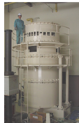
写真1 地盤作製用土槽
