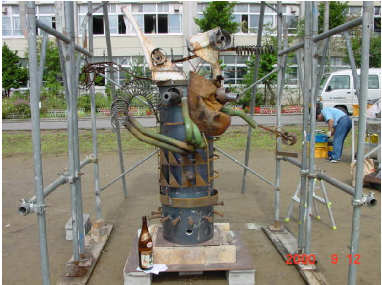
写真1 篠原氏が製作したたたら炉
