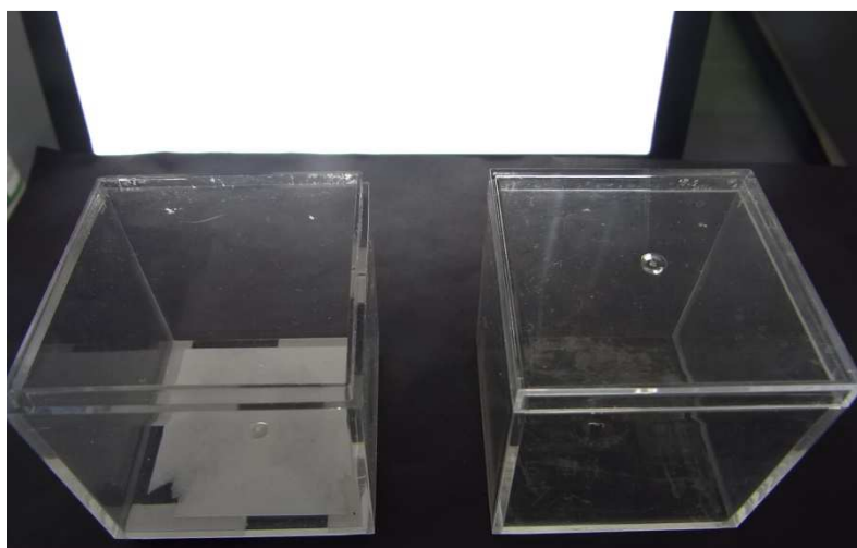
図 4-3-1-1 プラスチック製 50mm 角の供試体
