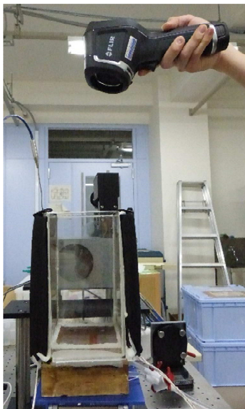
図 3.3.2 水平方向温度分布計測実験
