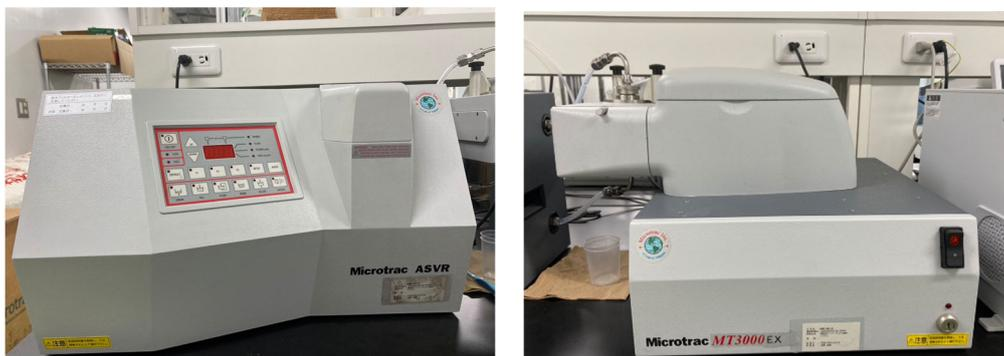
図 11 使用した粒子分布測定装置(マイクロトラック株式会社 MT3000)
