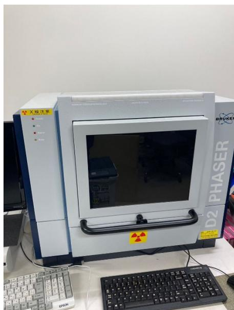
図9 使用した XRD 装置
