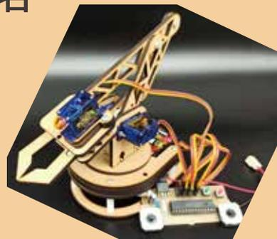
ニッパーやドライバーを使用しモーターや機構の動きを学習しながらロボットを作製します
