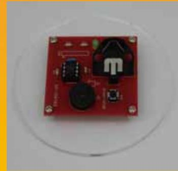
熱を感知してスタートする3分計を作製しながらはんだと電子工作の基礎を学びます
