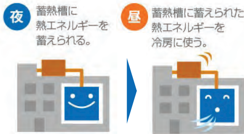
蓄熱式空調システムの冷房運転のイメージ図
