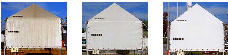
酸化チタン光触媒を塗布したテント素材 (屋外暴露5か月後の状態)
