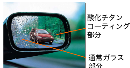
酸化チタンコーティング部分 通常ガラス部分 酸化チタン光触媒作用により表面が親水化するため曇りが生じない
