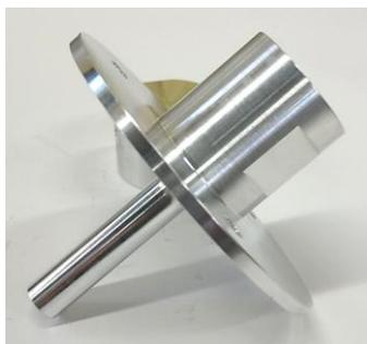
アルミ合金丸棒をNC旋盤で所要の形状に加工、ミニマシニングセンターで穴あけや平行部分の加工を行った。
