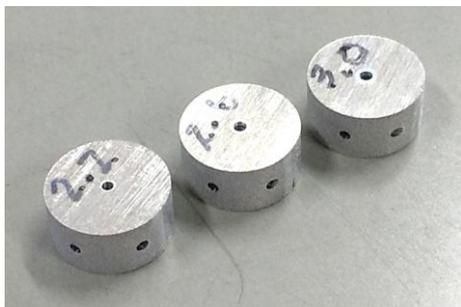
アルミ合金板をミニマシニングセンターでNCプログラム通りに穴あけ加工、最後にワイヤ放電加工機で円柱に切断加工を行った。
