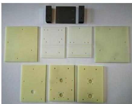
MCナイロン板、アルミ合金板、ステンレス角パイプをミニマシニングセンターで穴あけや溝加工を行い、最後にネジ立て加工を行った。
