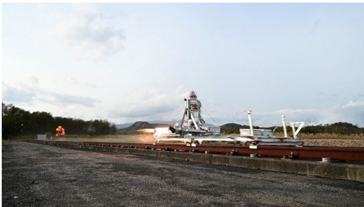
図1 ロケットスレッド設備 (ハイブリッドロケットでの加速)
