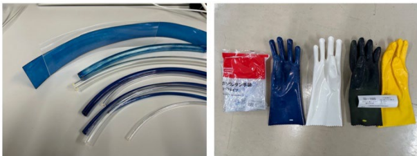
図 6 種々のポリウレタン製品の藍染試験
