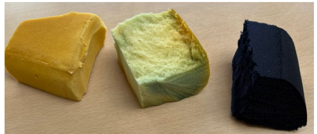
図1 藍染前後の PUF. 左：藍染前，中央：染液と数秒接触，右：染液中で吸水（絞る）・放水（解放する）を30秒間繰り返した
