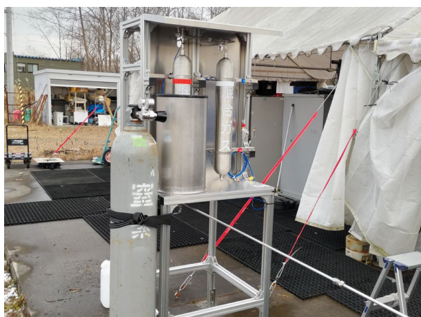
図 4 ニトロメタン燃焼試験設備
