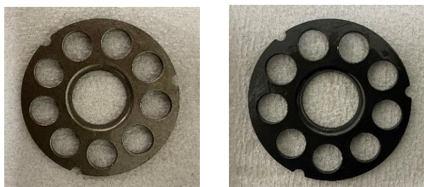
図 5 リテーナ（左：通常部品、右：DLC 加工部品）
