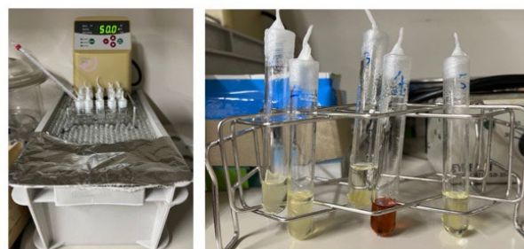
図1 PUに対する溶剤スクリーニング実験の外観
