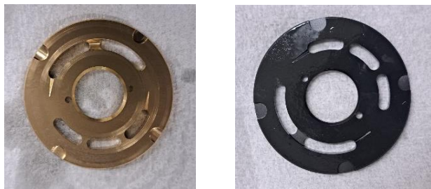
図 3 弁板（左：通常部品、右：DLC 加工部品）
