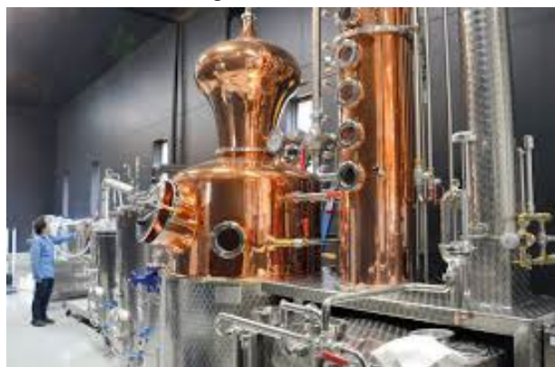
図 2 蒸留装置（積丹スピリット）
