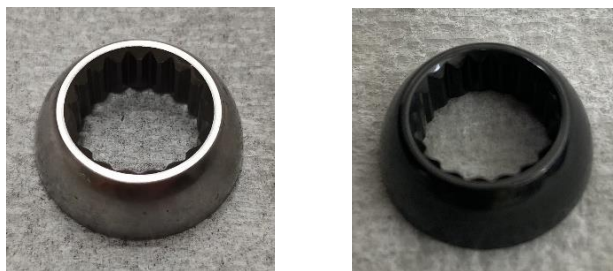
図 6 ピボット（左：通常部品、右：DLC 加工部品）
