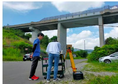
小型SARによる橋梁の振動計測
