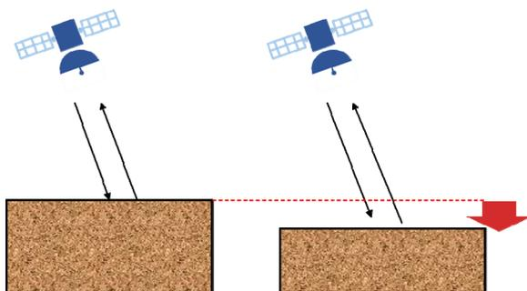
防災やインフラ管理のDX化を行う手段として近年衛星リモートセンシングが注目されている。特に、合成開口レーダ（SAR）によるリモートセンシングは夜間や荒天時でも対象の変位（隆起，沈下，振動）計測を行うことができるため，実利用の拡大において急速に成長している分野である。自然斜面やインフラ構造物の変位をSARにより高精度に計測する技術の確立を目指す。
