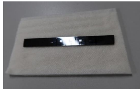
ビーム伝搬法により設計した試作光回路
