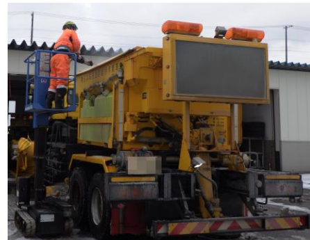
図1 凍結防止剤散布車の洗車のような
