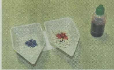
新開発薬剤の消石灰に滴下すると、劣化は赤く、劣化は青く変わる。
