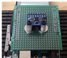
小型加速度/ジャイロセンサ+マイコン
