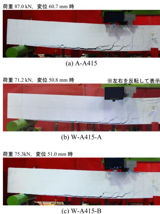
写真-1 剥離直前のひび割れ性状
