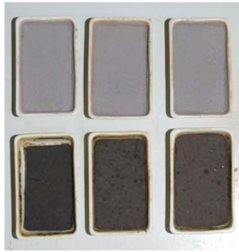
図1 フライアッシュと添加剤との混合物（上段）， およびそれらの焼成後（下段）
