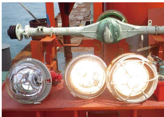
図 4 負荷をかける際に使用した 500W の白熱電球
