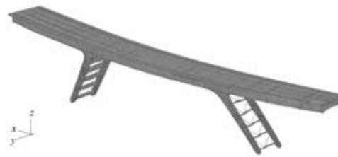
(a) 水平1次振動モード ( $f_{am}=1.87$  Hz)
