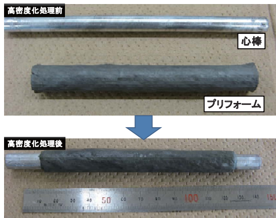
図4 高密度化前後のチューブプリフォームの様子
