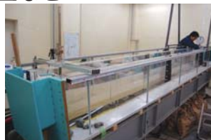
実験水路(長さ=5m, 幅=0.3m)
