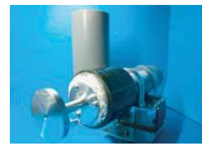
冬季屋外用強力空中超音波トランスデューサ
