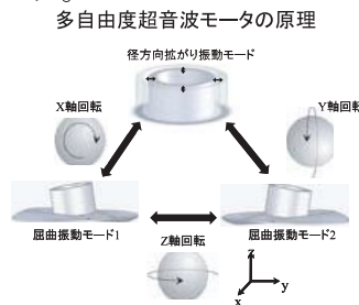
サンドウィッチ型多自由度球面超音波モータ 小型・軽量で高トルク発生
