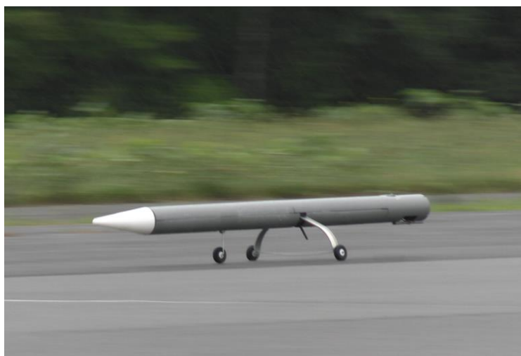
図 1 滑走試験機体による自動滑走制御の様子
