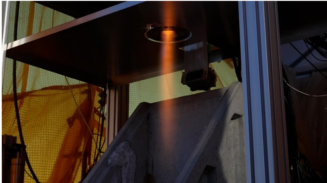
デトネーションエンジン地上燃焼試験 (2/28 実施)
