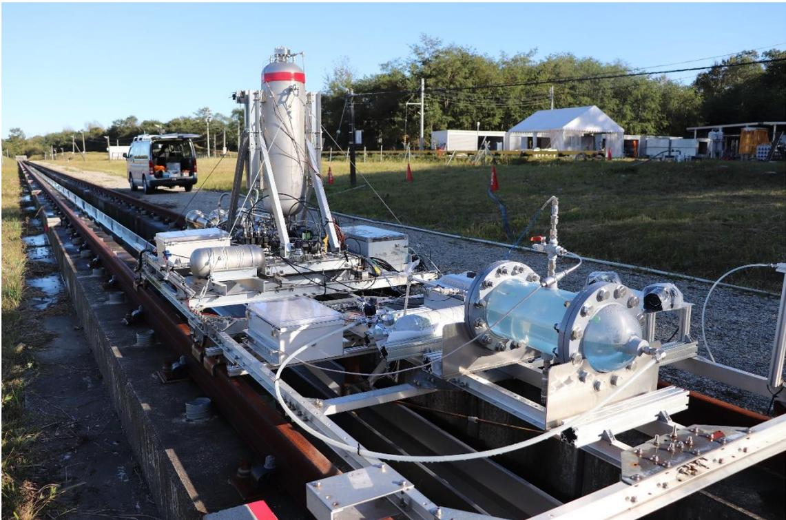
超音速機の推進タンク内部の推進は、飛行中に発生する加速度変動により揺動する。この際に加圧ガスが推進に随伴し、推進排出がスムーズに行われず、エンジンの不具合をもたらすことがある。このようなガス巻き込みを抑制する一手法として表面張力を利用した気液分離、推進捕捉機構をタンク内部の推進排出口に設置し、ロケットスレッド走行試験により直線的な加減速  $G$  を与えてその効果を評価した。透明塩化ビニルを用いたタンクの内部液位および排出口付近の挙動を機上搭載カメラで撮影したデータを CFD 計算結果と比較してまとめる次第である。
