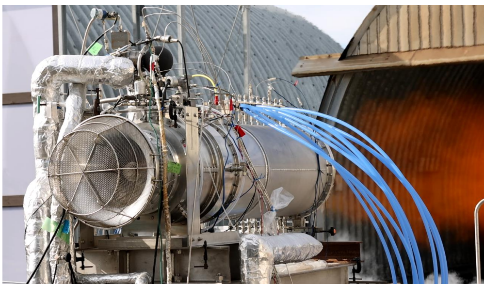
エアターボラムジェット（ATR）エンジン燃焼試験の様子
