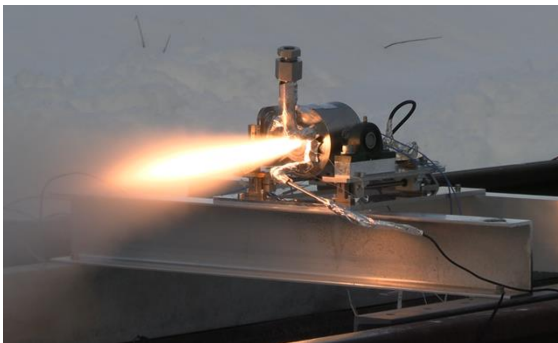
図1 固体ロケットモーター燃焼試験の様子
