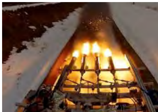
図7 走行時の機上搭載カメラからのロケット火炎画像
