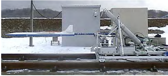
図1 高速走行台車に設置された 1/3 スケール縮小機体および計測機器
