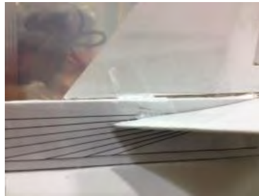
図4 エレベータ舵角の設定方法
