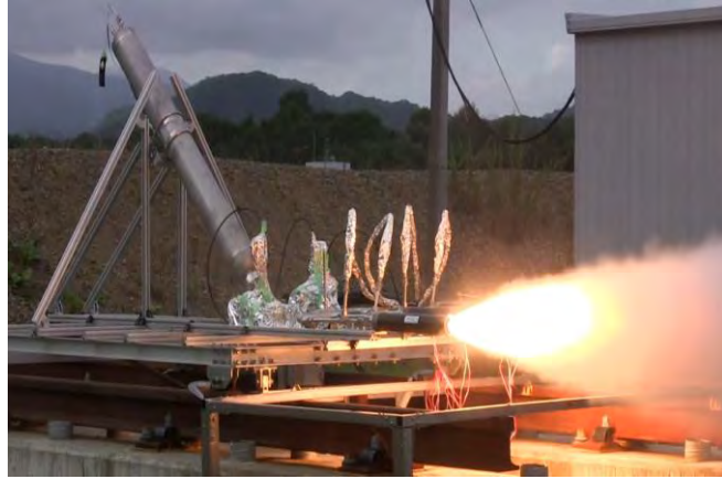
図5 ハイブリッドロケットクラスタ燃焼試験 (2015.8.29)
