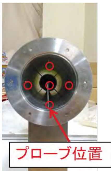
図6 回流式低速風洞によるGN 2 混合試験の結果 左：酸素濃度測定箇所 右：酸素濃度の時間履歴結果
