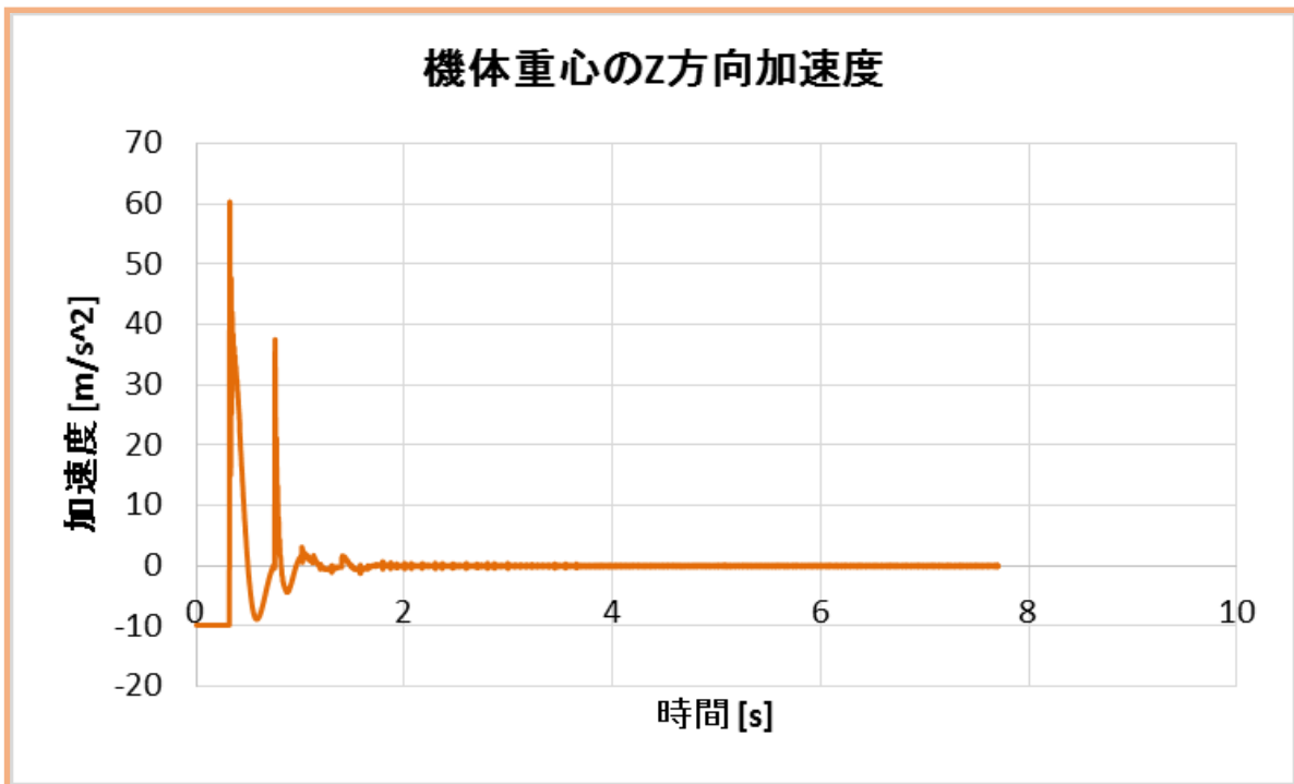
図7 迎角に合わせて傾けたトラス型主脚構造案における機軸鉛直方向衝撃加速度
