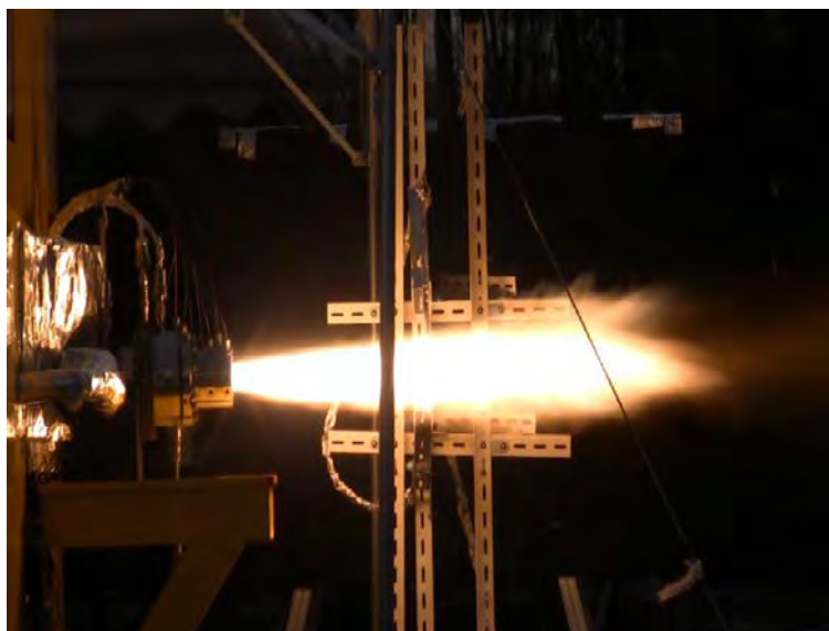
図1 炭化水素系ロケットエンジンの燃焼試験
