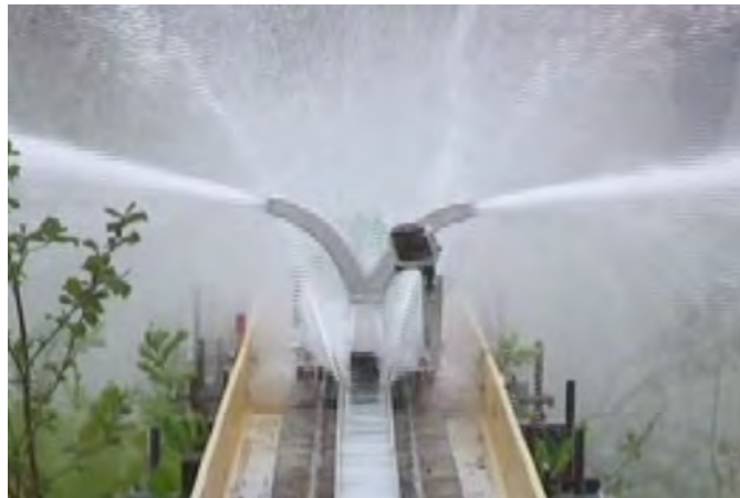
図3 すくいあげた水を左右に噴射するインテーク型制動板
