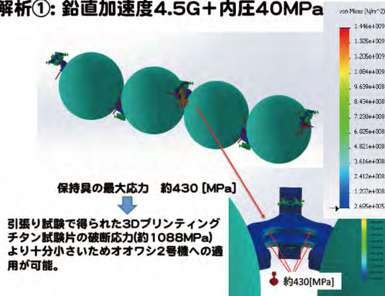
図 1 1 高圧気蓄器保持金具の解析条件
