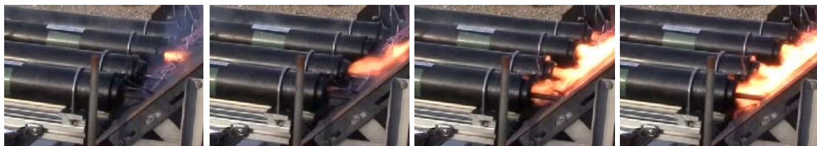
図6: 加速用ハイブリッドロケット4本クラスタ時の着火ばらつきの様子(左端から右端まで 0.5 秒)
