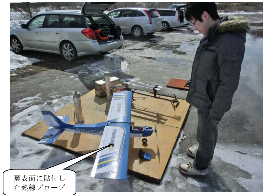
JAXA が開発したデータロガー搭載と翼表面にセンサーを貼付した電動ラジコン機
