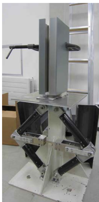
図15: 設計製作した落下式 衝撃引張試験装置
