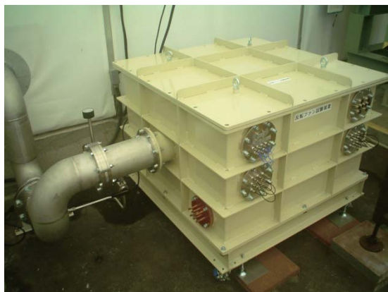
図3 設置後の反転ファン試験装置真空槽
