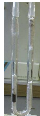
図 2 パルス式反応装置概略図・反応管写真
