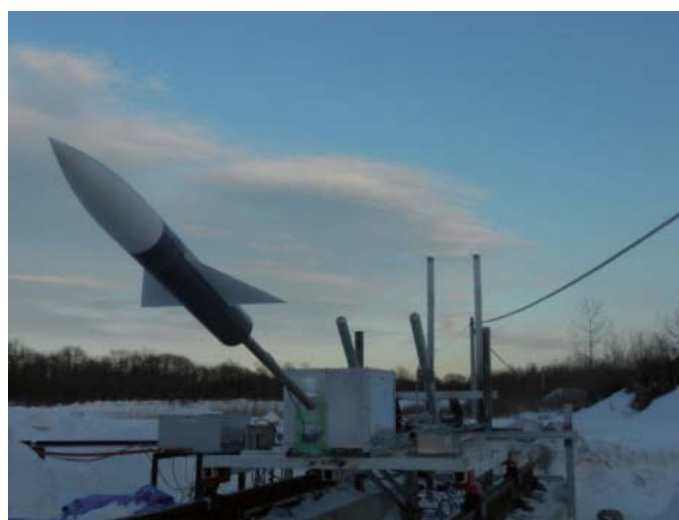
図7:天秤に取り付けられた AGARD-B 模型
