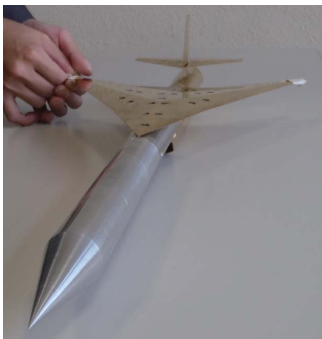
(b) ベースライン形状の風試模型の外観(ノーズ A、インテーク B)
