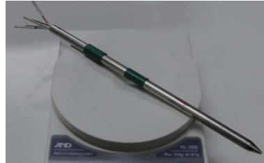
図3. 5 孔ピトー管と圧力センサーボード
