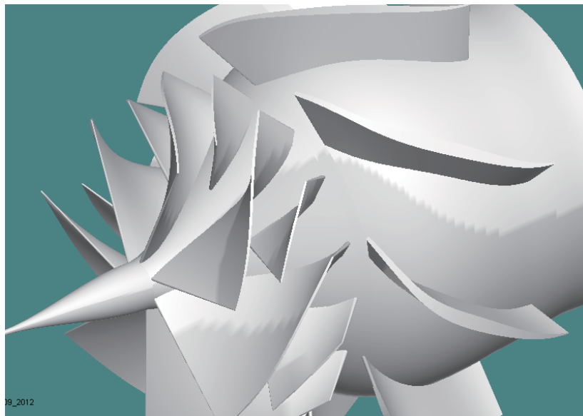
図 1 GG-ATR エンジン用斜流圧縮機形状
