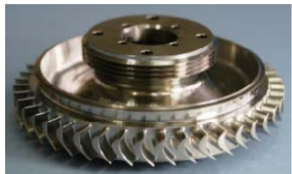
図 6 製作した高圧タービンブリスク
