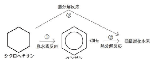
図 1 シクロヘキサン反応経路図
