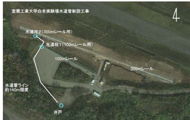
図2: 高圧水道管敷設経路図
