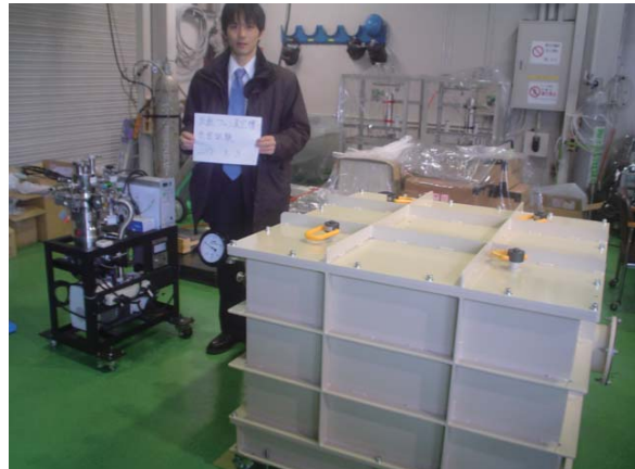
図2 真空槽単体の真空引き試験
